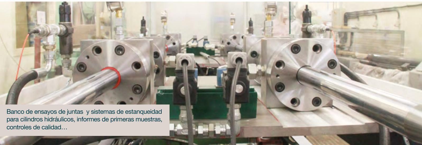
Banco de ensayos de juntas y sistemas de estanqueidad para cilindros hidráulicos, informes de primeras muestras, controles de calidad...
