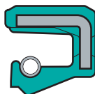
Versión BA (A DIN 3760) Recubrimiento exterior liso.
