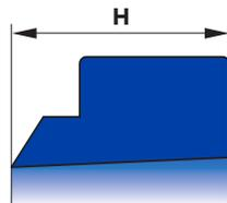
Los chaflanes de montaje deben ser los mismos que para la junta de vástago. Radios, según indicaciones del plano.
