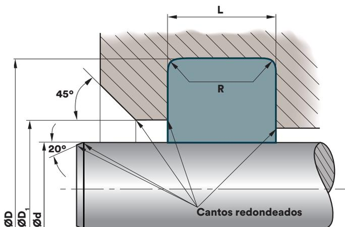
Los chaflanes de montaje deben ser los mismos que para la junta de vástago. Radios, según indicaciones del plano.
